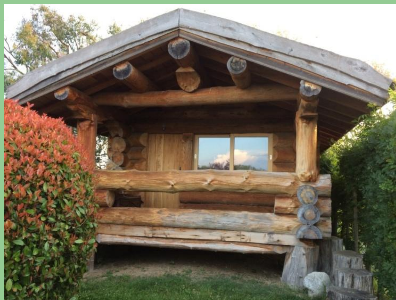
Cabane de jardin en pin maritime sur pilotis d'acacia et toiture végétalisée
