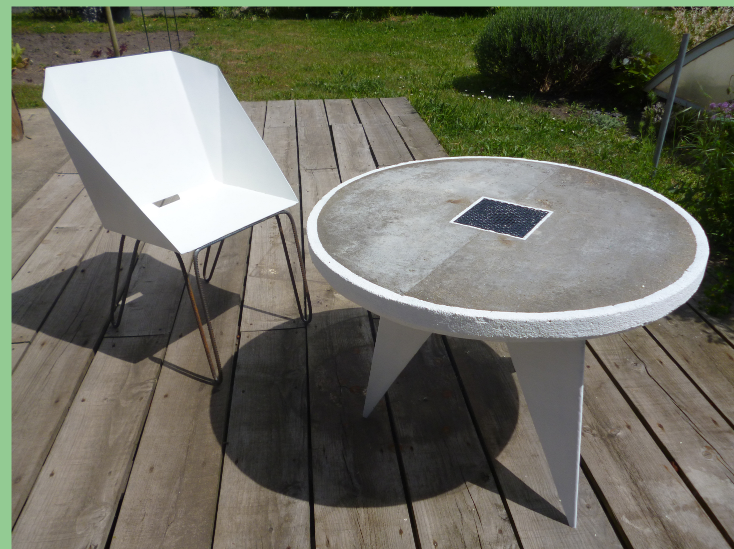
Réalisation d'une chaise en acier plié et pied fer à béton, table basse en béton/acier peint
